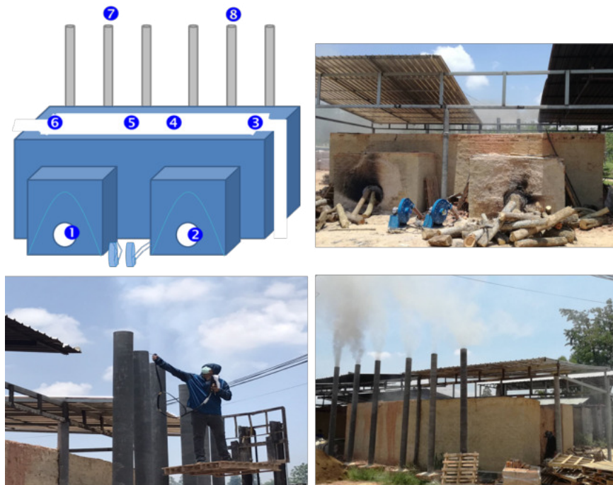
ภาพที่ 2 ตำแหน่งตรวจวัดอุณหภูมิและแก๊สเสียและลักษณะเตาเผาอิฐมอญเชื้อเพลิงชีวมวลแบบถาวรหลังเตา
