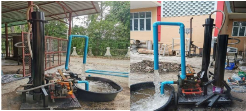
ภาพที่ 1 ระบบแก๊สซีไฟเออร์สำหรับการสูบน้ำในงานวิจัยนี้
